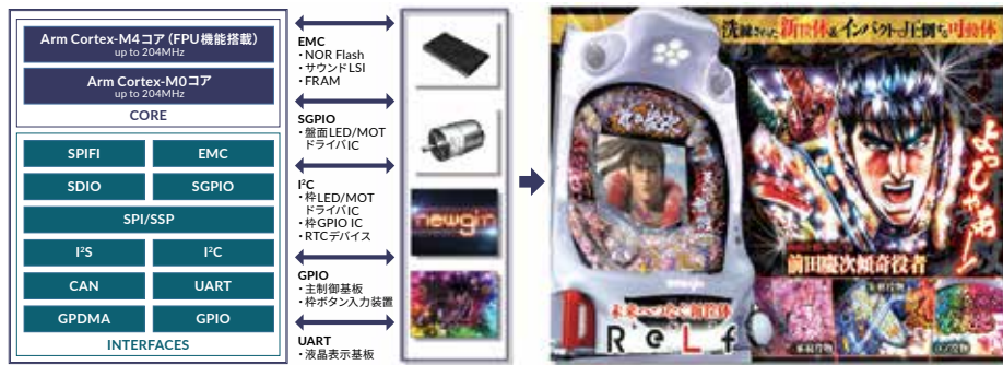
図2：演出制御基板の機能の概要。
